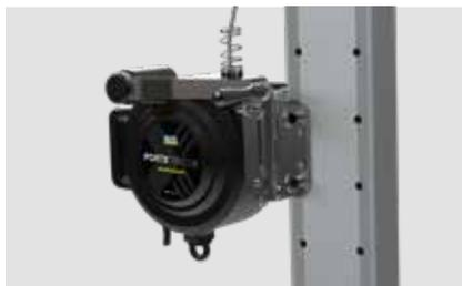
Em todas as colunas verticais, o suporte é fixado conforme ilustrado, utilizando pinos. A largura das abas varia consoante o produto ao qual está fixado.
