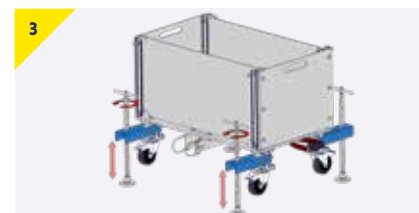
Actionner les pieds réglables en hauteur jusqu'à la hauteur requise.
