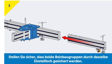
Stellen Sie sicher, dass beide Beinbaugruppen durch dasselbe Einstelloch gesichert werden.
