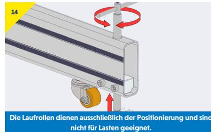
Die Laufrollen dienen ausschließlich der Positionierung und sind nicht für Lasten geeignet.
