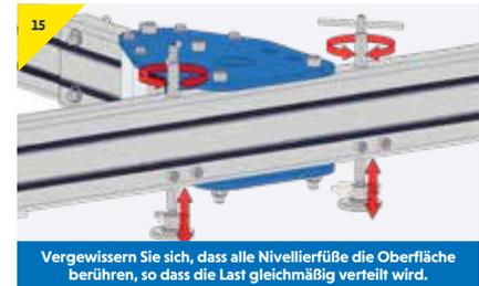
Vergewissern Sie sich, dass alle Nivellierfüße die Oberfläche berühren, so dass die Last gleichmäßig verteilt wird.
